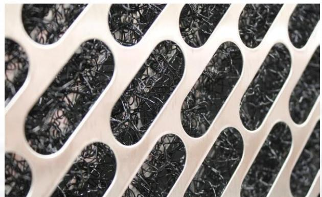
Zum Schutz der Kondensatoren verfügen alle MCHILL-Kühler über progressive Verbundfasernetzfilter, die für den Service und die Reinigung leicht entfernt werden können. Der Edelstahlrahmen verhindert Korrosion auch beim Waschen des Filters mit Wasser oder anderen Waschflüssigkeiten .
