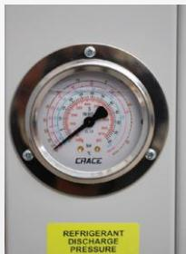
Alle MCHILL-Modelle verfügen über ein als Standard verbautes Kältemittel-Hoch- und Niederdruckmanometer.
